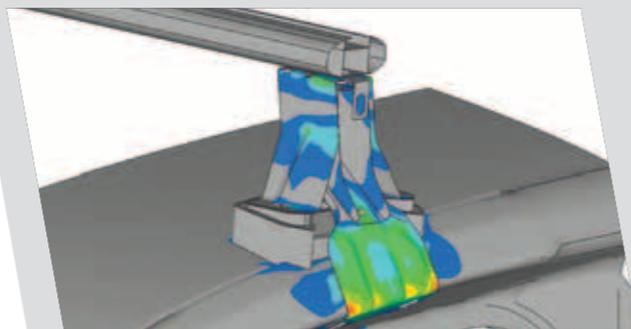
Рейлинги проходят ряд комплексных испытаний. При различных условиях тестируется их устойчивость к коррозии, грузоподъемность, прочность и долговечность. Кроме того, при установке оборудования проверяется водонепроницаемость автомобиля. В ходе так называемого городского краш-теста рейлинг с багажом в 90 кг должен удержаться на крыше при воздействии на него силы примерно в 12 G, действующей в течение 50 миллисекунд (имитация столкновения).
