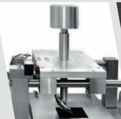
Устройство для «испытания каблуком»
