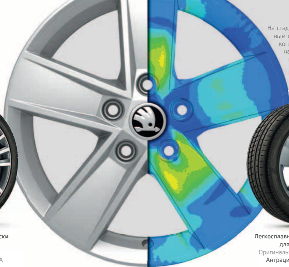
На стадиях разработки и испытаний моделируются все возможные ситуации с участием автомобиля. Испытания по методу конечных элементов (FEM), результаты которых показаны на изображении, позволяют выявить недостаточную прочность легкосплавного диска до начала серийного производства. Этот метод применяется для обеспечения максимального качества оригинальных аксессуаров ŠKODA.
