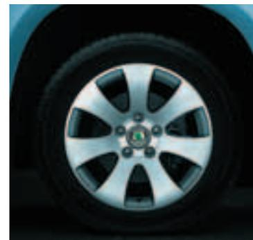
Легкосплавный колесный диск 7.0J x 16"
