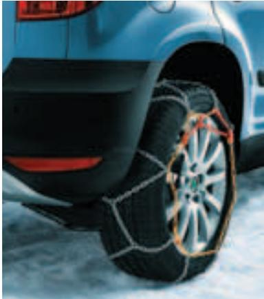
**Зимние цепи** для шин 205/55 R16 и 205/50 R17 (СЕР 800 001); подходят для легкосплавных дисков 6.0J x 17" **Flash** (ССХ 800 003)
