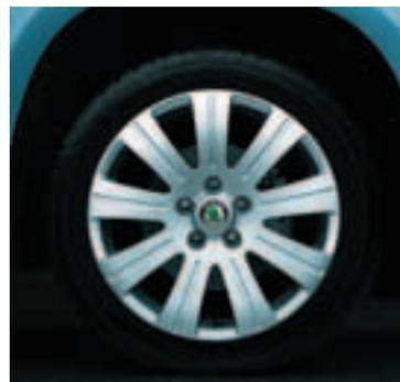
Легкосплавный колесный диск 6.0J x 17"
