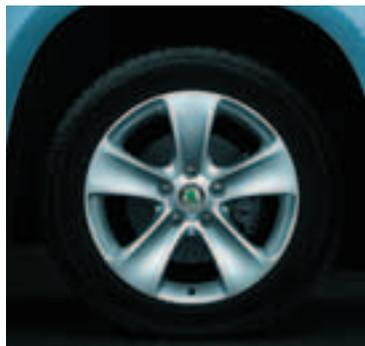
Легкосплавный колесный диск 7.0J x 16"
