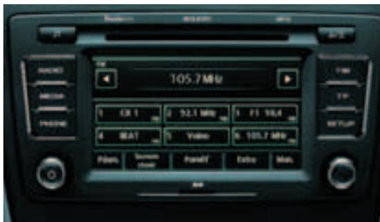
**Магнитола Volero:** встроенный CD-проигрыватель на 6 дисков; устройство чтения карт SD, MMC для проигрывания файлов формата CD/MP3/WMA; усилитель 4 x 20 W; цифровой процессор с эквалайзером; цветной сенсорный дисплей 6.5"; отображение информации системы Climatronic, датчиков парковки, времени и внешней температуры (IZO 035 156M)
