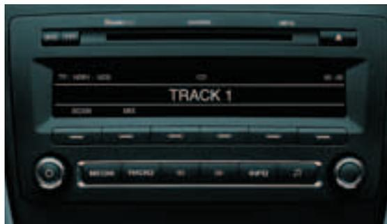
**Магнитола Swing:** CD-привод чтения CD/MP3/WMA, усилитель 4 x 20 W, цифровой процессор с эквалайзером (IZO 035 161M)
