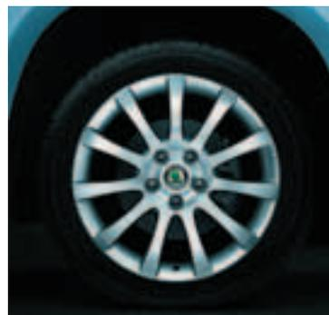
Легкосплавный колесный диск 7.0J x 17"
