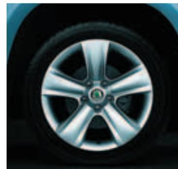
Легкосплавный колесный диск 7.0J x 17"
