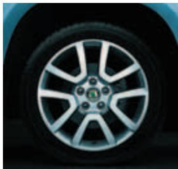
Легкосплавный колесный диск 7.0J x 17"
